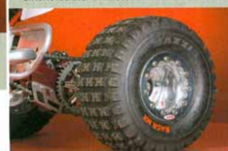
LLANTAS OMF de aluminio con refuerzos exteriores atornillados.
