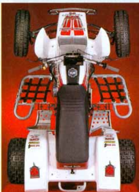
LA POSICIÓN DE CONDUCCIÓN ha variado poco: el manillar es más plano, y los estríberos están más altos y adelantados
