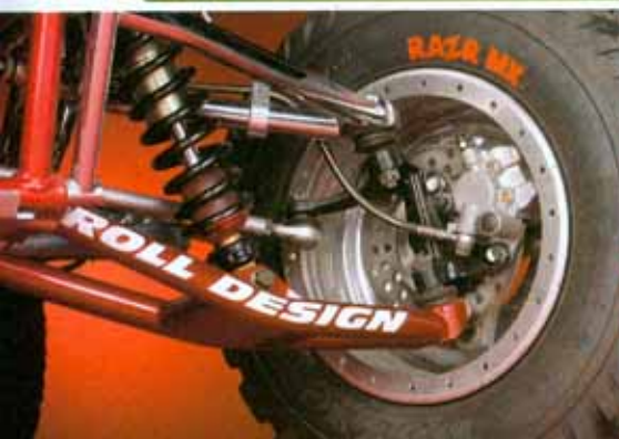
PINZAS Y BOMBA DE FRENO ORIGINALES. Si cambian maneta, latiguillos (inextensibles) y discos.
