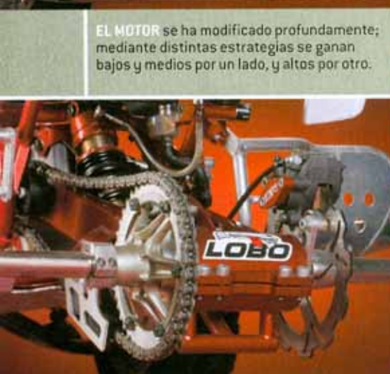
BASCULANTE ROLL DESIGN; juego de bieletas original y monoamortiguador Elka multirregulable.
