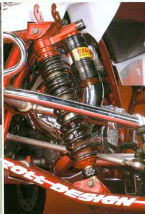
TRAPECIOS ROLL DESIGN en forma de banana para poder alojar a los amortiguadores Elka Long Travel multirregulables.
