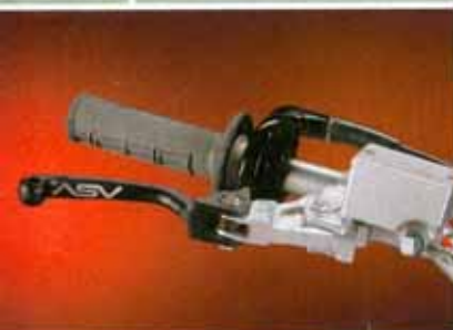
MANETA ASV flexible y obtenida a partir del mecanizado de una única pieza, para mayor resistencia.
