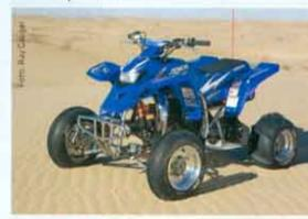
EN EL BLASTER que ves en las fotos se han montado unos trapecios Laeger's 5 cm. más anchos y un eje Teamensanchado en la misma proporción. Los neumáticos no son particularmente anchos para una menor superficie de rozamiento; se aprovecha asi la ligereza del quad.
