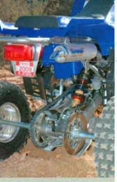
mantiene el basculante original, pero se cambia el monoamortiguador original por un Elka multirregulable. Eje Team mas ancho que el de serie.
