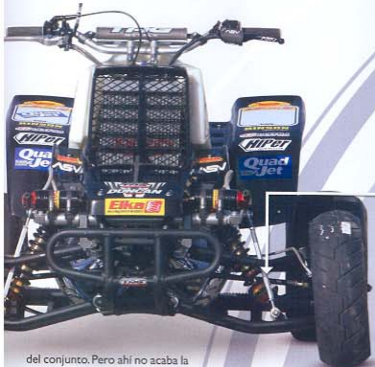
ELKA SUPERMOTO, TRAPECIOS Y ESTABILIZADORA LONESTAR. La anchura aumenta unos centímetros, lo suficiente para disponer de mayor apoyo en todo tipo de curvas.
