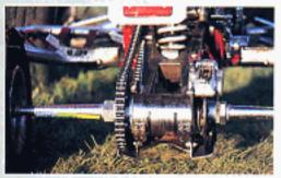
L'arbre est un Durablue de type Eliminator à roulements coniques, quant au disque flottant arrière, il s'agit d'un ATV World.
